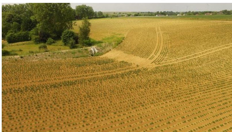
Zone d'immersion temporaire en zone cultivée, destinée à intercepter du ruissellement agricole avant une zone urbanisée.
