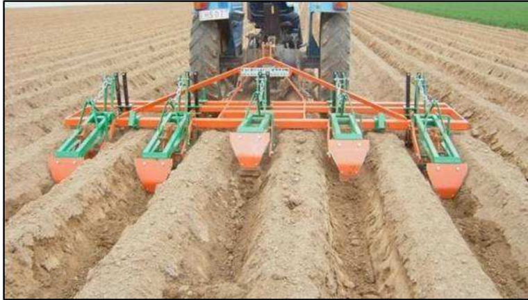
Le cloisonnement des interbuttes en pomme de terre, correctement utilisé, permet de limiter en partie le ruissellement lors des premiers orages survenant avant le développement de la culture (Photo : FIWAP )
