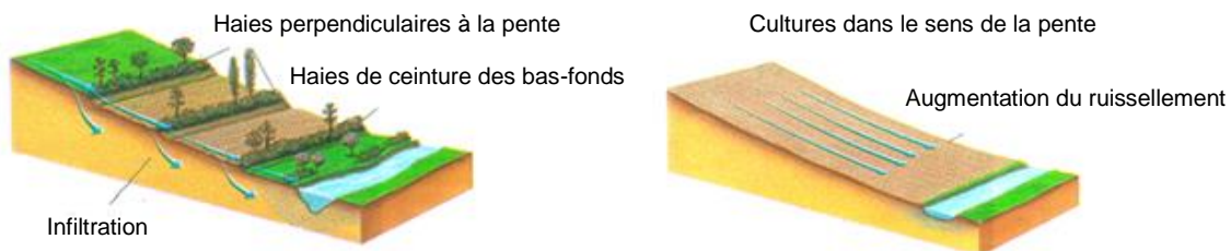
Schémas explicatifs de l'influence des pratiques agricoles sur le ruissellement. (Source : inspiré de l'étude ENSEIHT sur la sécheresse en Ile-et-Vilaine)
