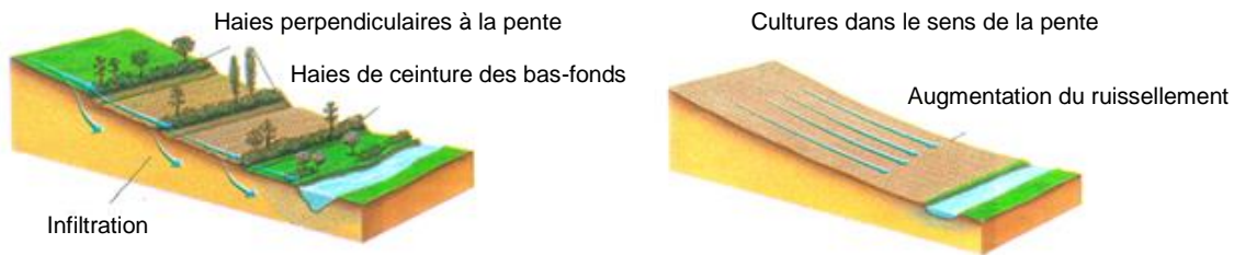
Figure 13 : Schémas explicatifs de l'influence des pratiques agricoles sur le ruissellement. (Source : inspiré de l'étude ENSEIHT sur la sécheresse en Ile-et-Vilaine)
