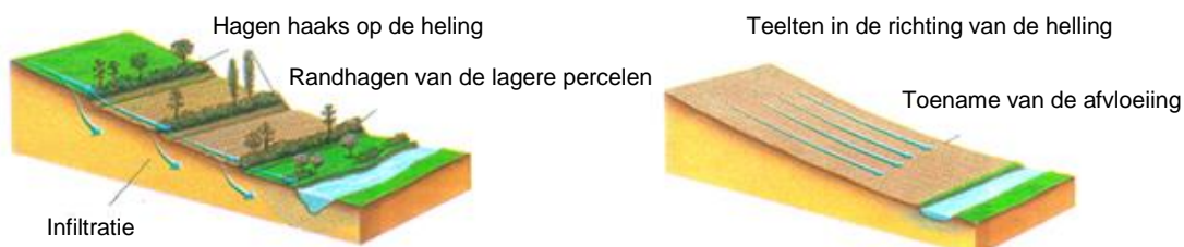
Afbeelding13: Schema's die de invloed van de landbouwpraktijken op de afvloeiing verklaren. (Bron: geïnspireerd op de studie van de ENSEEIHT over de droogte in Ille-et-Vilaine)
