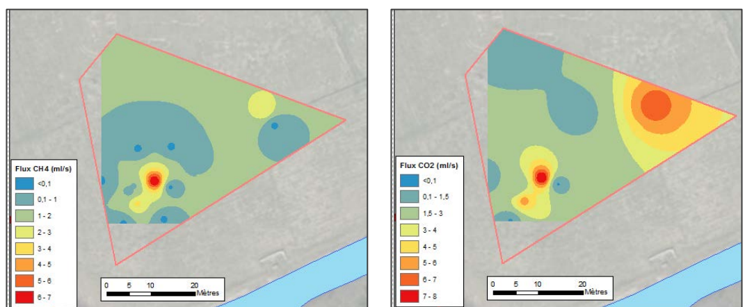
Figure 9 : Interpolations des flux locaux de \text{CH}_4 et \text{CO}_2 (ml/s) sur la zone émissive
