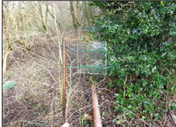
**Support pour diatomées disposées dans le ruisseau en amont et en aval du rejet STEP**
