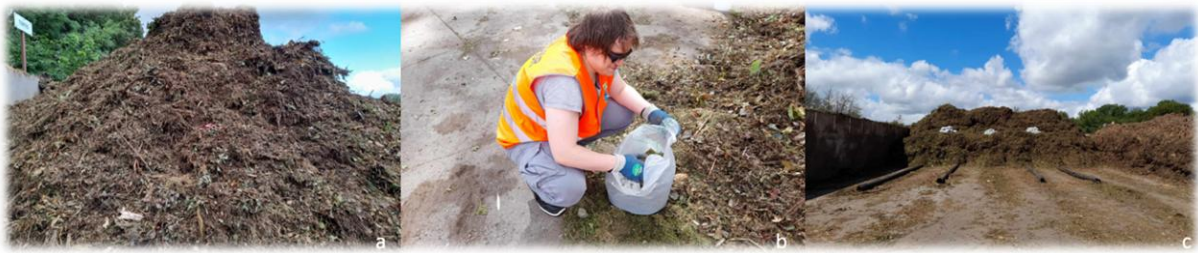
FIGURE 35 : BROyat UTILISÉ POUR CRÉER LE TAS EXPÉRIMENTAL (A), REMPLISSAGE DES SACS À L'AIDE DU BROyat (B) ET DISPOSITION DES SACS SUR LE TAS EXPÉRIMENTAL (C)
