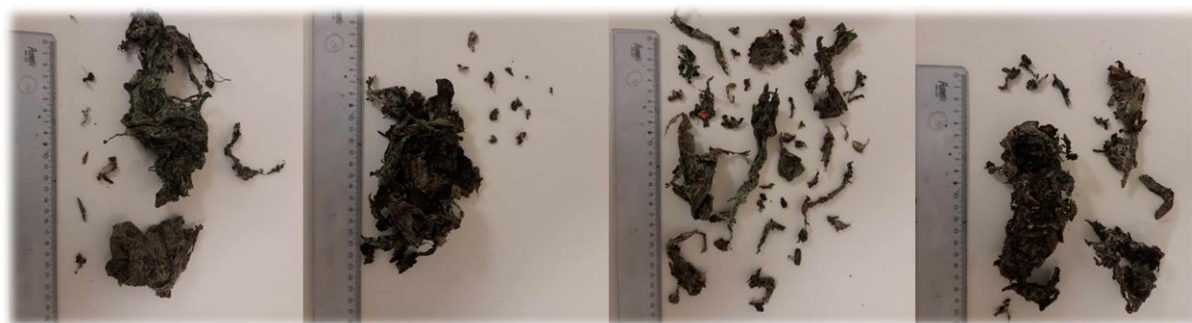
FIGURE 26 : PHOTOGRAPHIES DU PLASTIQUE PRÉSENT DANS LE REFUS À 2 MM ISSU DES QUATRE ÉCHANTILLONS DE COMPOST MATURE PRÉLEVÉ DANS LES FûTS EXPÉRIMENTAUX AYANT INCORPORÉ LE SAC B DANS LEURS AJOUTS HEBDOMADAIRES
