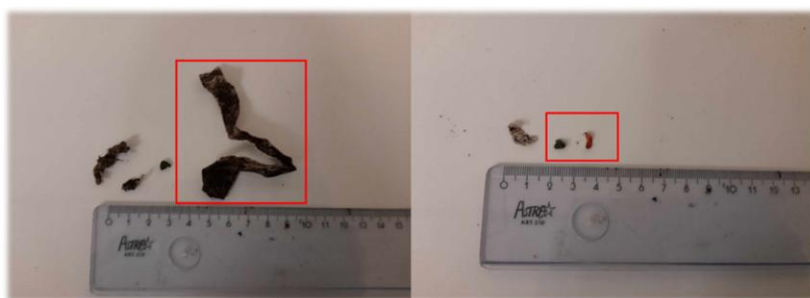
FIGURE 29 : PHOTOGRAPHIES DU PLASTIQUE PRÉSENT DANS LE REFUS À 2 MM DE DEUX ÉCHANTILLONS DE MATRICE EXPÉRIMENTALE PRÉLEVÉS DANS LE SYSTÈME N°1 AU MOMENT DE LA ROTATION N°2
