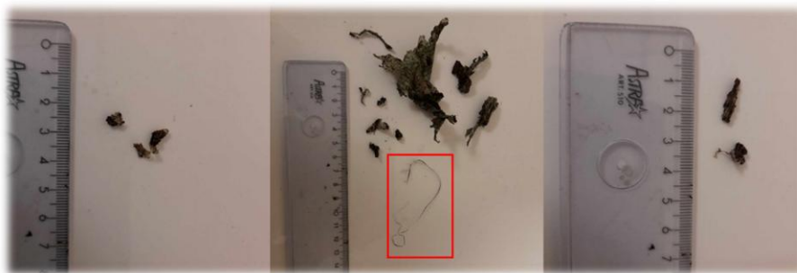
FIGURE 30 : PHOTOGRAPHIES DU PLASTIQUE PRÉSENT DANS LE REFUS À 2 MM DES TROIS ÉCHANTILLONS DE MATRICE EXPÉRIMENTALE PRÉLEVÉS DANS LE SYSTÈME N°2 AU MOMENT DE LA ROTATION N°2
