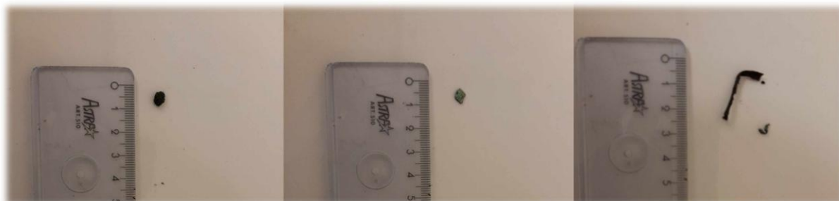
FIGURE 44 : PHOTOGRAPHIES DU PLASTIQUE PRÉSENT DANS LE REFUS À 2 MM DES TROIS ÉCHANTILLONS DE COMPOST MATURE PRÉLEVÉS DANS LA SECTION EXPÉRIMENTALE COMPORTANT LE SAC D
