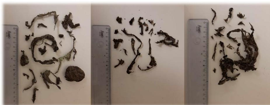
FIGURE 22 : PHOTOGRAPHIES DU PLASTIQUE PRÉSENT DANS LE REFUS À 2 MM DES TROIS ÉCHANTILLONS DE MATRICE EXPÉRIMENTALE PRÉLEVÉS DANS LES FÛTS AYANT INCORPORÉ LE SAC A DANS LEURS AJOUTS HEBDOMADAIRES
