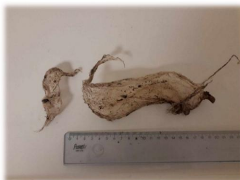
FIGURE 24 : PHOTOGRAPHIE DE MORCEAUX DÉCHIRÉS DU SAC C PRÉSENTS DANS LE REFUS À 2 MM DE L'UN DES TROIS ÉCHANTILLONS DE MATRICE EXPÉRIMENTALE PRÉLEVÉE DANS LES FûTS AUXQUELS IL A ÉTÉ AJOUTÉ HEBDOMADAIREMENT
