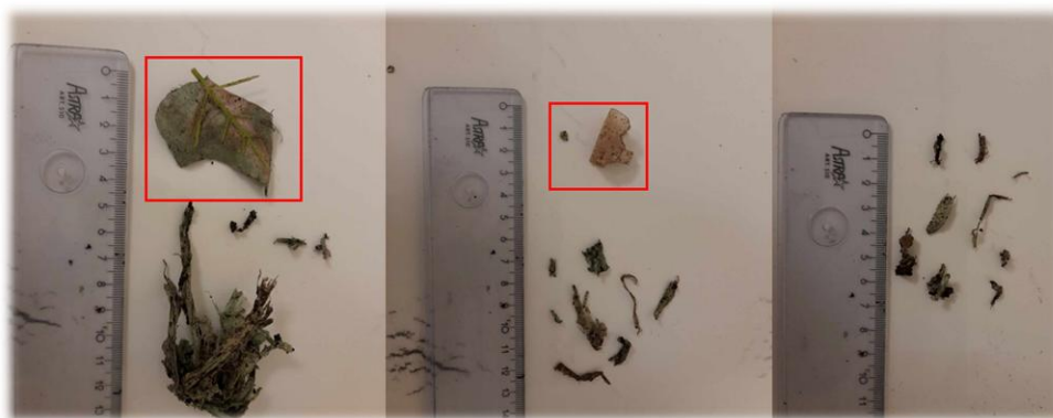
FIGURE 32 : PHOTOGRAPHIES DU PLASTIQUE PRÉSENT DANS LE REFUS À 2 MM DES TROIS ÉCHANTILLONS DE COMPOST MATURE PRÉLEVÉS DANS LE SYSTÈME N°2 AU MOMENT DE LA ROTATION N°3
