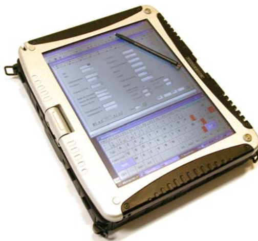
Figure 5.1. - Encodeur PANASONIC (modèle) utilisé pour la récolte des données sur le terrain.
