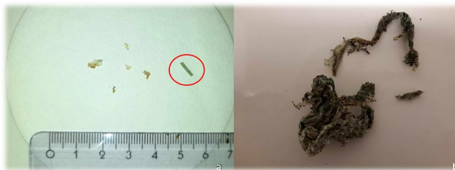
FIGURE 9 : IDENTIFICATION D'UN MICROPLASTIQUE EXTERNE À L'ÉTUDE PARMI DES MICROPLASTIQUES ISSU DE L'UN DES SACS TESTÉS (A) ; LAMBEAUX DE SACS COMPORTANT DES INSCRIPTIONS PRÉSENTS DANS DU COMPOST MATURE (B)
