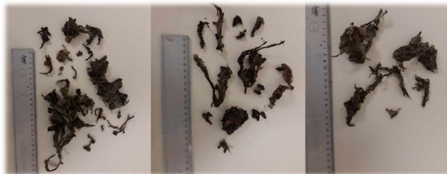
FIGURE 25 : PHOTOGRAPHIES DU PLASTIQUE PRÉSENT DANS LE REFUS À 2 MM DES TROIS ÉCHANTILLONS DE COMPOST MATURE PRÉLEVÉ DANS LES FûTS EXPÉRIMENTAUX AYANT INCORPORÉ LE SAC A DANS LEURS AJOUTS HEBDOMADAIRES
