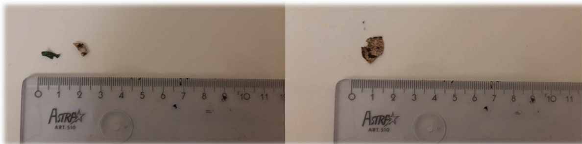
FIGURE 45 : PHOTOGRAPHIES DU PLASTIQUE PRÉSENT DANS LE REFUS À 2 MM DE DEUX ÉCHANTILLONS DE COMPOST MATURE PRÉLEVÉS DANS LA SECTION EXPÉRIMENTALE COMPORTANT LE SAC E
