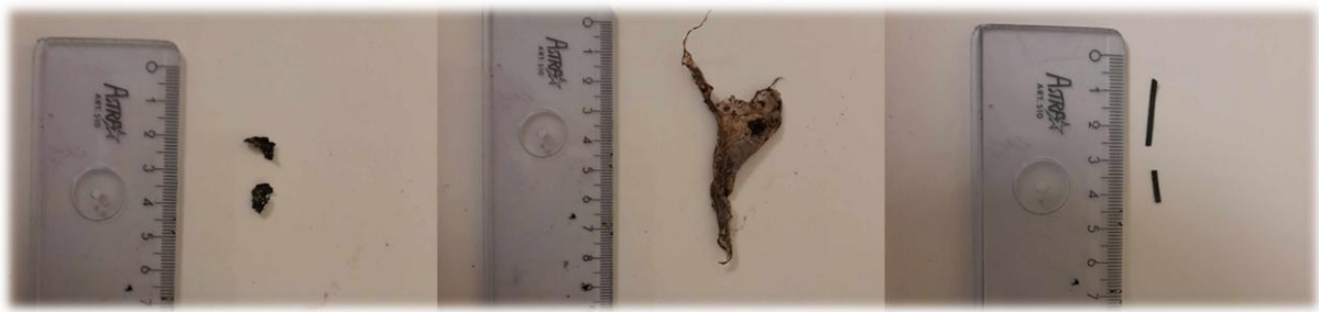
FIGURE 28 : PHOTOGRAPHIES DU PLASTIQUE PRÉSENT DANS LE REFUS À 2 MM D'UN ÉCHANTILLON DE MATRICE EXPÉRIMENTALE PRÉLEVÉS DANS LES SYSTÈMES N°2, N°3 ET N°4 AU MOMENT DE LA ROTATION N°1 (DE GAUCHE À DROITE : ÉCHANTILLON DU SYSTÈME N°2, ÉCHANTILLON DU SYSTÈME N°3, ÉCHANTILLON DU SYSTÈME N°4)
