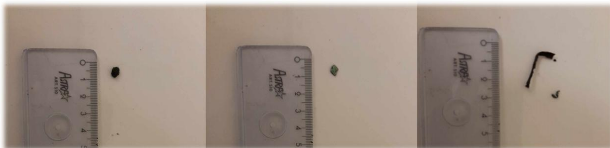
FIGURE 44 : PHOTOGRAPHIES DU PLASTIQUE PRÉSENT DANS LE REFUS À 2 MM DES TROIS ÉCHANTILLONS DE COMPOST MATURE PRÉLEVÉS DANS LA SECTION EXPÉRIMENTALE COMPORTANT LE SAC D
