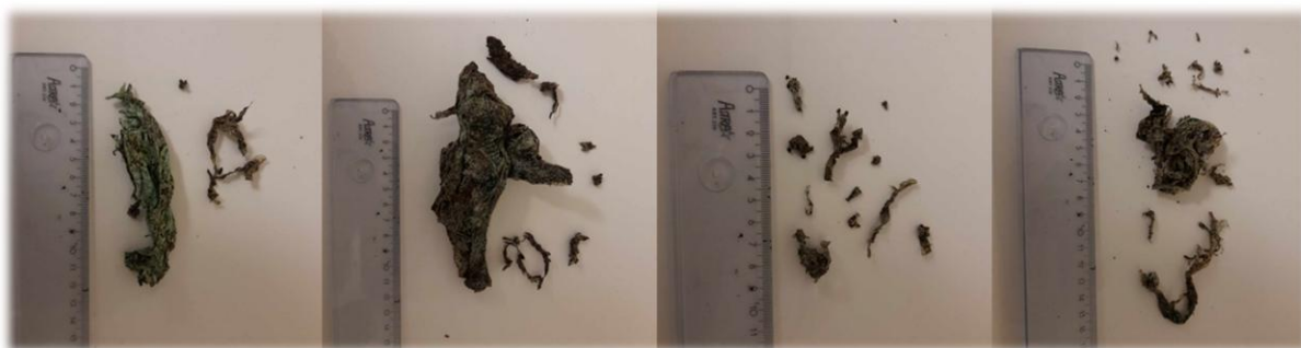
FIGURE 23 : PHOTOGRAPHIES DU PLASTIQUE PRÉSENT DANS LE REFUS À 2 MM DES QUATRE ÉCHANTILLONS DE MATRICE EXPÉRIMENTALE PRÉLEVÉS DANS LES FûTS AYANT INCORPORÉ LE SAC B DANS LEURS AJOUTS HEBDOMADAIRES
