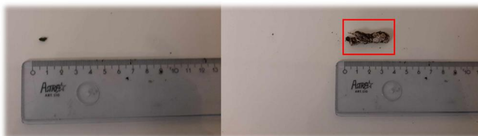
FIGURE 31 : PHOTOGRAPHIE DU PLASTIQUE PRÉSENT DANS LE REFUS À 2 MM DE DEUX ÉCHANTILLONS DE COMPOST MATURE PRÉLEVÉS DANS LE SYSTÈME N°1 AU MOMENT DE LA ROTATION N°3
