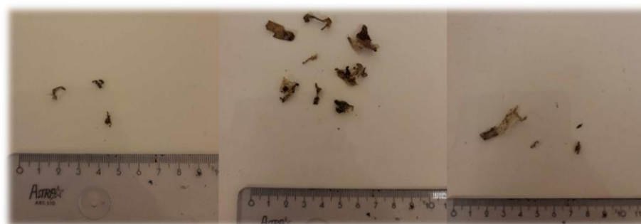
FIGURE 27 : PHOTOGRAPHIES DU PLASTIQUE PRÉSENT DANS LE REFUS À 2 MM DES TROIS ÉCHANTILLONS DE MATRICE EXPÉRIMENTALE PRÉLEVÉS DANS LE SYSTÈME N°1 AU MOMENT DE LA ROTATION N°1
