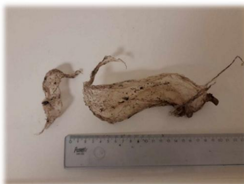
FIGURE 24 : PHOTOGRAPHIE DE MORCEAUX DÉCHIRÉS DU SAC C PRÉSENTS DANS LE REFUS À 2 MM DE L'UN DES TROIS ÉCHANTILLONS DE MATRICE EXPÉRIMENTALE PRÉLEVÉE DANS LES FûTS AUXQUELS IL A ÉTÉ AJOUTÉ HEBDOMADAIEMENT
