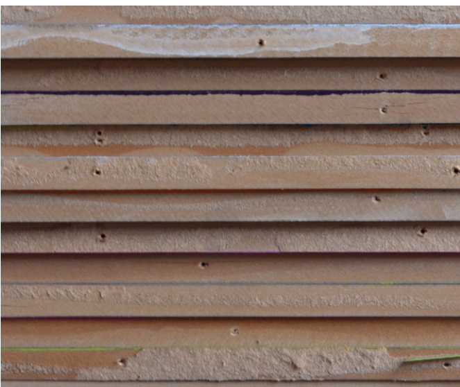
Les panneaux de MDF démantelés, Ressourcerie Namuroise
