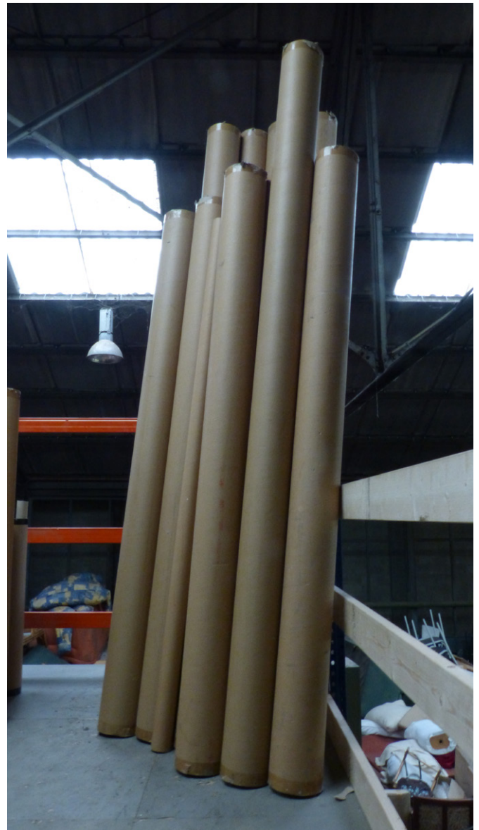
Les mandrins bruts mis de côté pour les poteaux et les poutres, RN.
