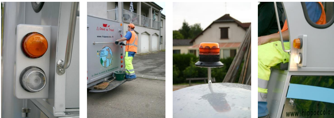
Exemple d'équipements de sécurité sur les bennes servant à la collecte hippomobile
