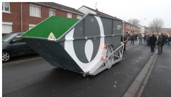
Exemple d'équipements de sécurité sur les bennes servant à la collecte hippomobile
