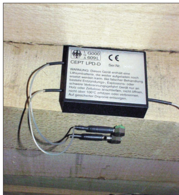
Système de mesure de l'humidité du bois avec transmission des données par ondes radio
