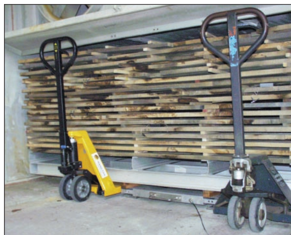
Mise en place d'une charge de planchettes de chêne dans la cellule de séchage
