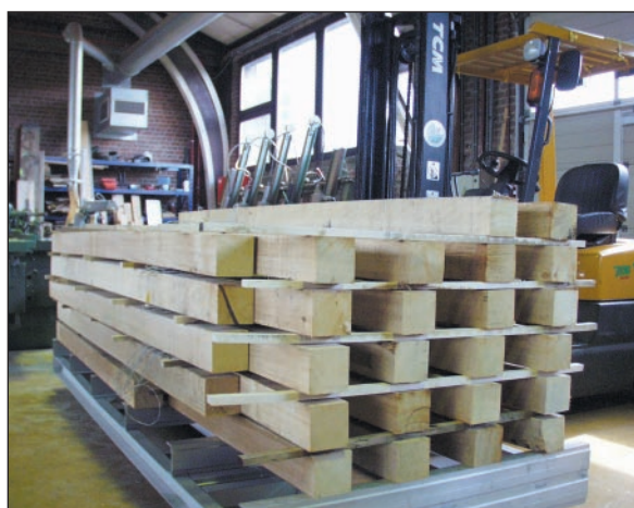
Carrelets de hêtre soumis à un traitement curatif par séchage
