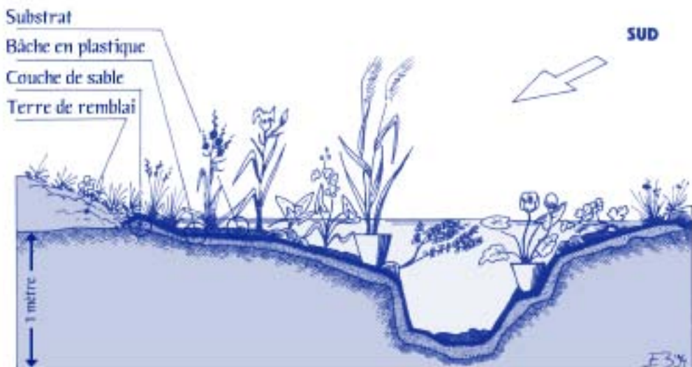
Figure 3 : réalisation de la mare et installation de la végétation.
