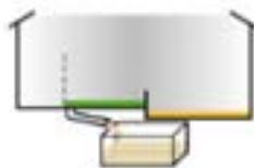
Fläche mit Stroheinstreu und abgeschabter Gang ohne Stroheinstreu mit Stufe und Trennmauer.
