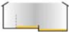
Fläche mit Stroheinstreu und abgeschabter Gang mit Stroheinstreu mit Stufe und Trennmauer.
