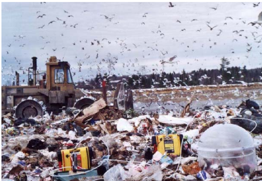
Figure 22 : Fonctionnement de la chambre de flux ODOFLUX de la firme canadienne Odotech (photo extraite de leur site Internet)
