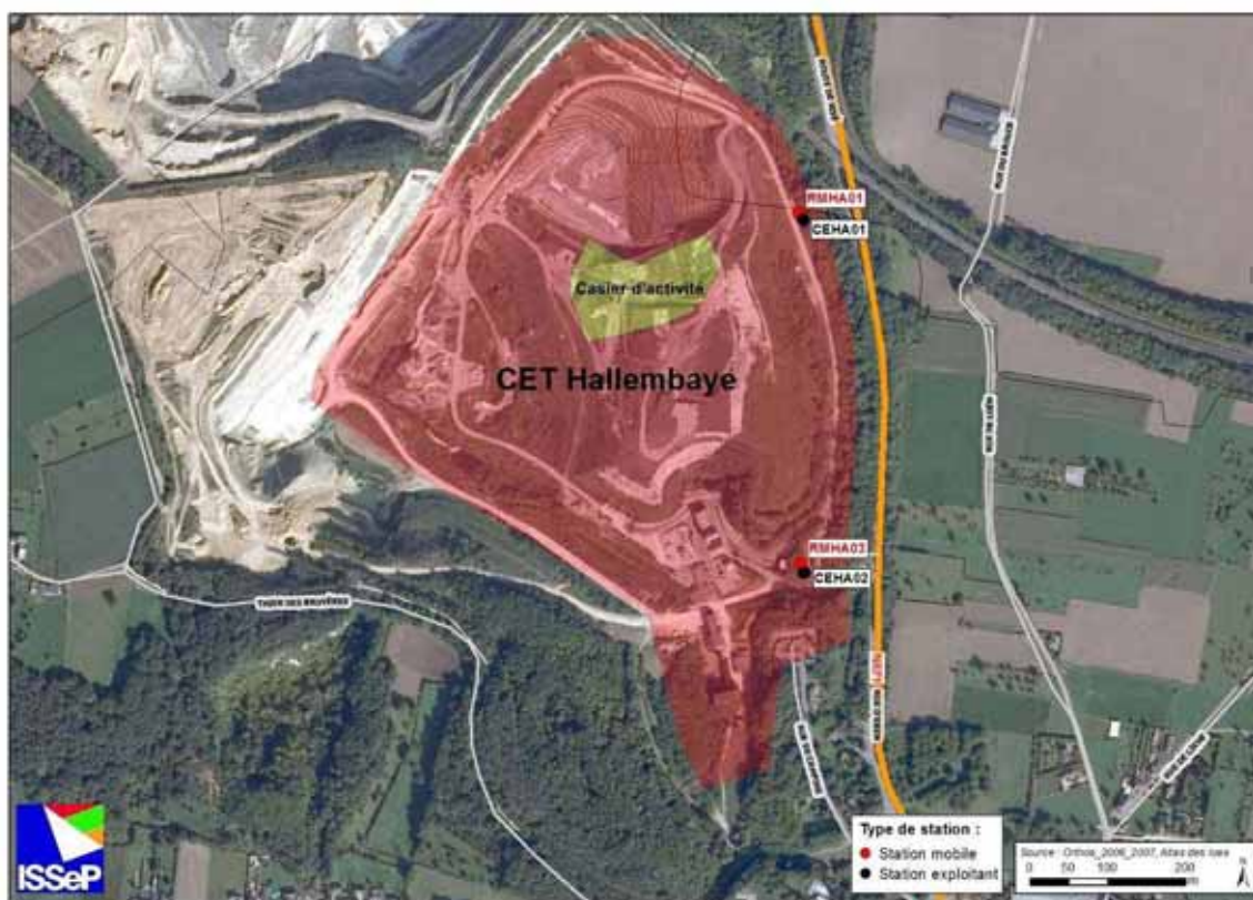
Figure 43 : Emplacement des stations de mesures de la qualité de l'air (source : rapport ISSeP n°6466/2010)
