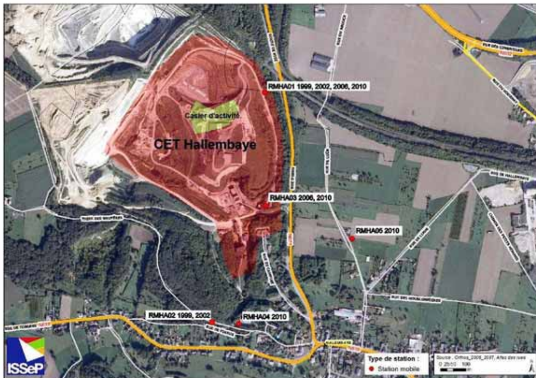
Figure 46 : Implantation des cabines de contrôle de la qualité de l'air de l'exploitant et de l'ISSeP lors des différentes campagnes de contrôle
