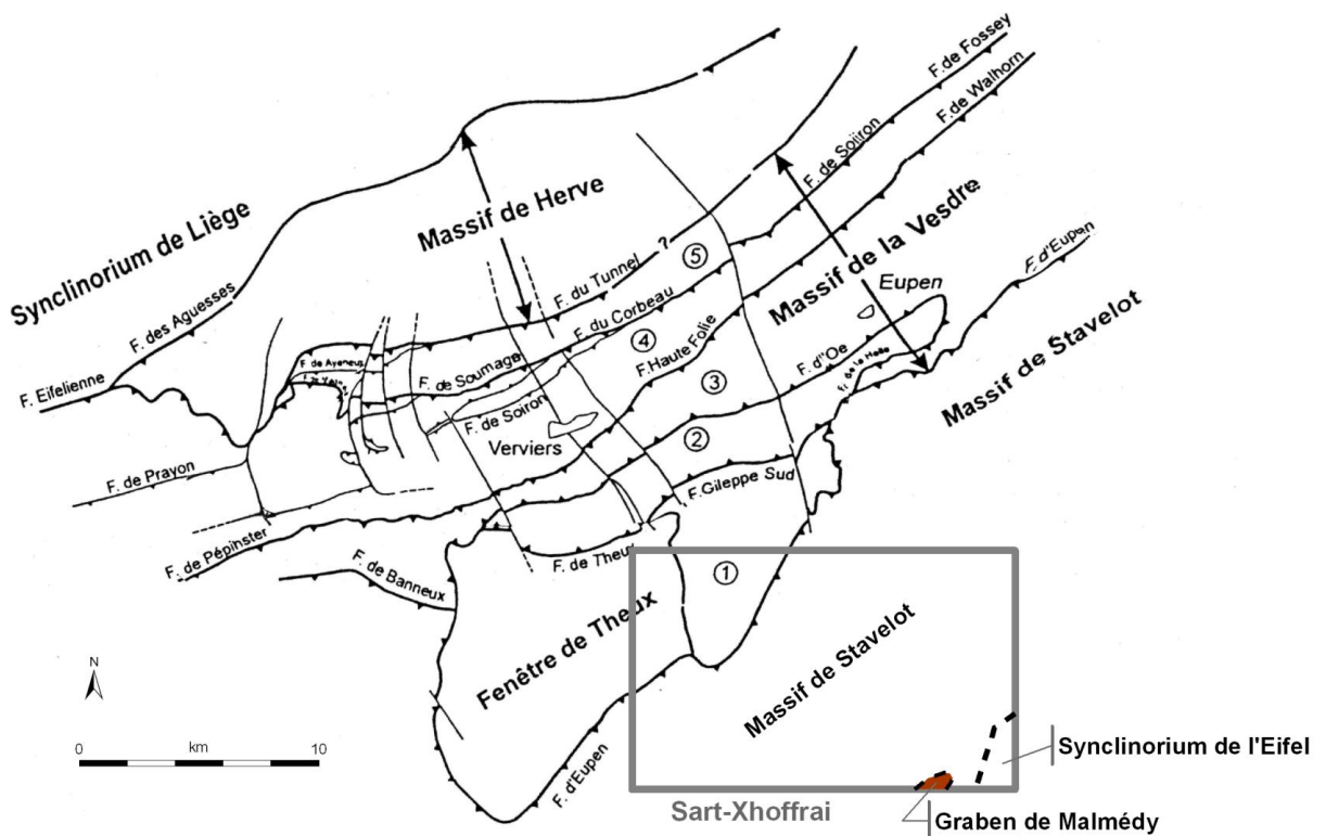
Figure III.6 : Carte structurale schématique de l'Est de la Belgique avec indication des unités structurales de la Nappe de la Vesdre : 1. Unité de Jalhay ; 2. Unité de la Gileppe ; 3. Unité de Goé ; 4. Unité de Forêt-Andrimont ; 5. Unité du Tunnel ( Laloux et al., 1997 ; modifié )
