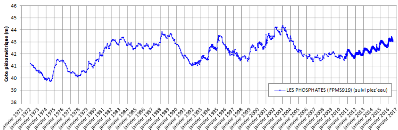
Figure IV—12. Evolution piézométrique dans « Les Phosphates » implanté dans l'Aquifère des craies du Crétacé.
