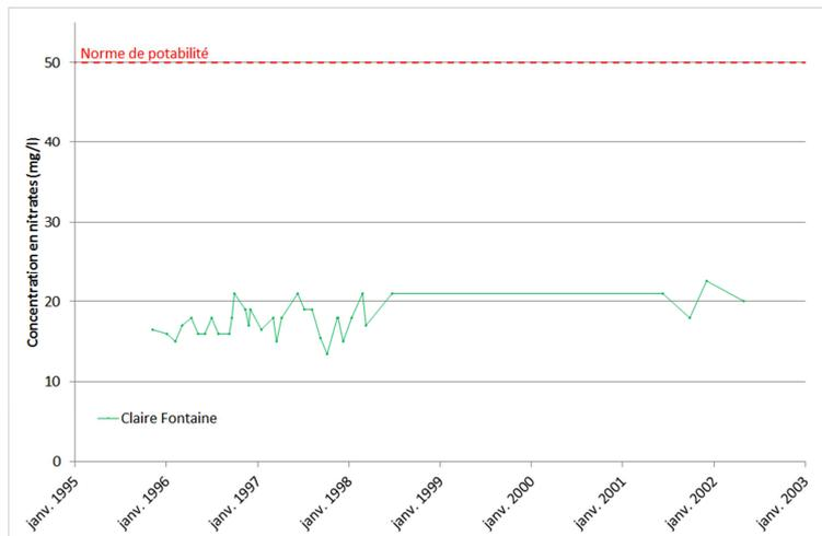
**Figure V.7. Evolution de la teneur en nitrates dans un ouvrage de l'aquiclude à niveaux aquifères du Houiller**
